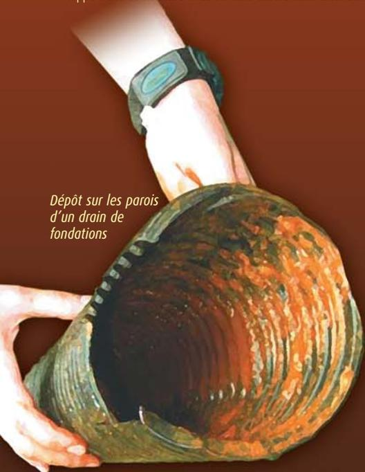
Dépôt sur les parois d'un drain de fondations
